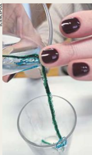
Im Versuch fließt das Wasser die Schnur entlang, weil die Wassermoleküle die Stofffasern durchdringen und die Schnur entlang wandern
