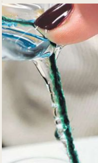
Im Versuch fließt das Wasser die Schnur entlang, weil die Wassermoleküle die Stofffasern durchdringen und die Schnur entlang wandern
